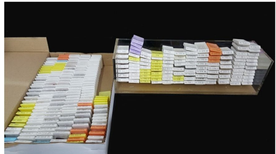
รูปที่ 3 แสดงการจัดเรียงพาราฟินบล็อกแบบใช้อุปกรณ์ช่วยจัดเรียงพาราฟินบล็อก
